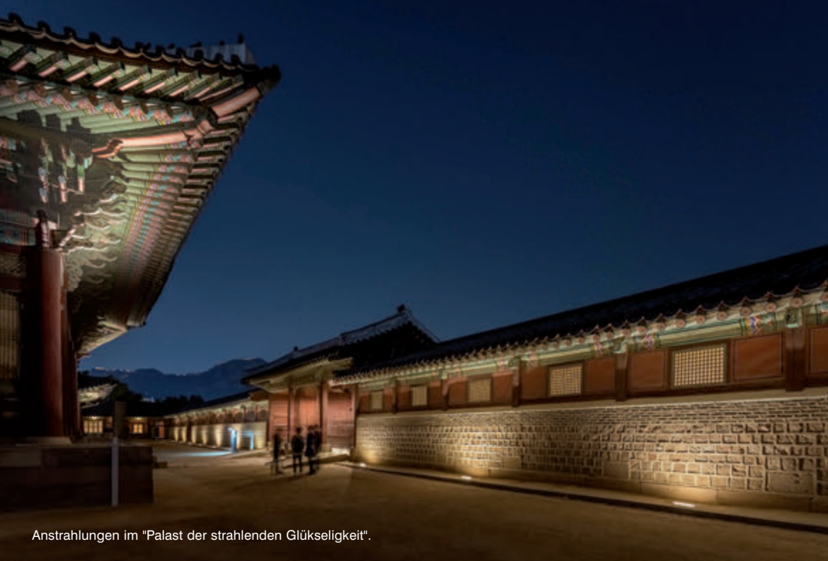
Das Gebäude wird aus 70 m Entfernung durch insgesamt 10 an zwei Masten montierten Scheinwerfern beleuchtet.
