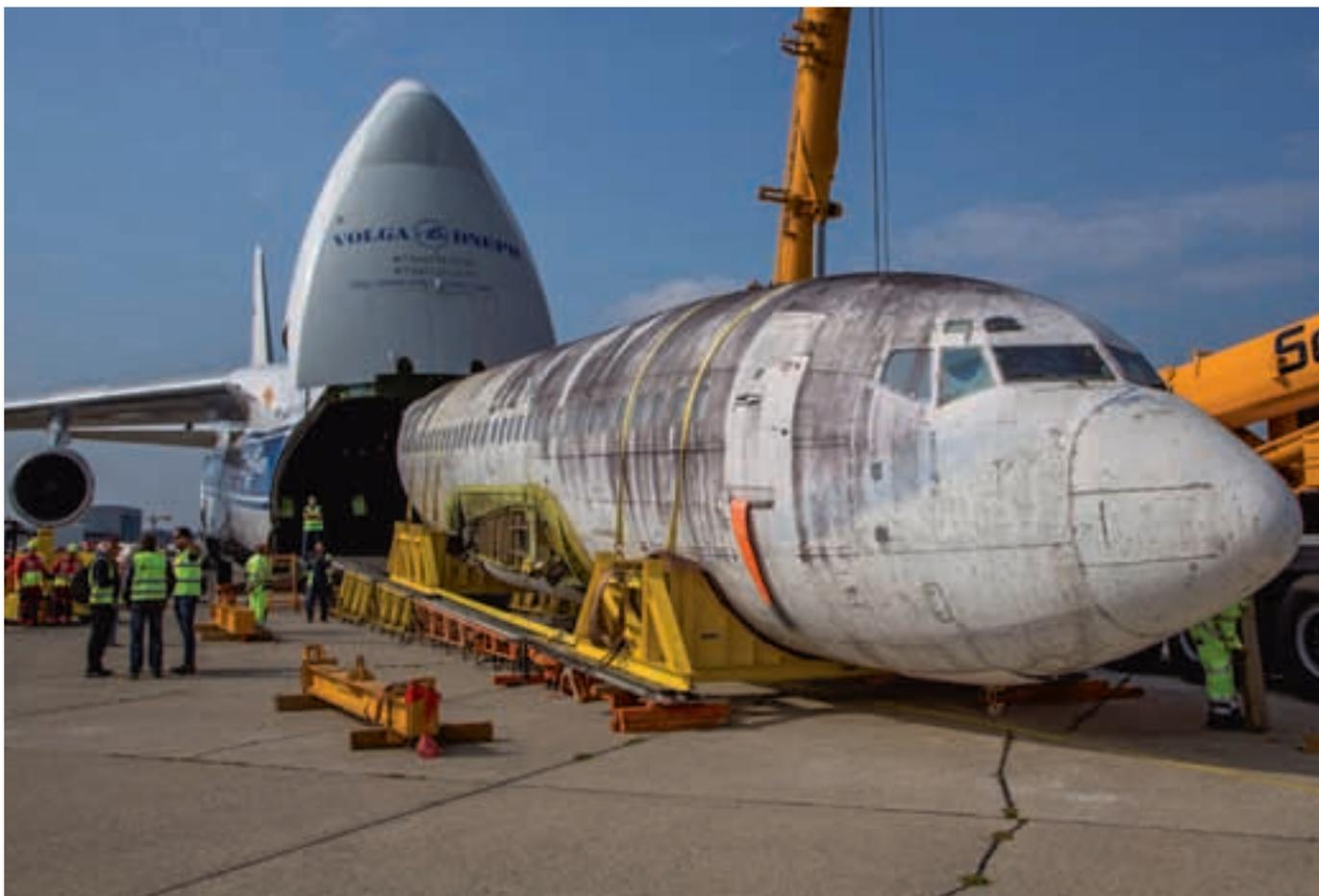
Auf einem Spezialgestell wird die Landshut aus dem Bauch der Antonow gezogen, um anschließend mittels zweier Autokrane auf einen Tieflader gehievt zu werden
