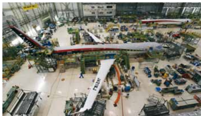
Endmontage des zweiten und dritten Prototyps des Mitsubishi Regional Jets.
