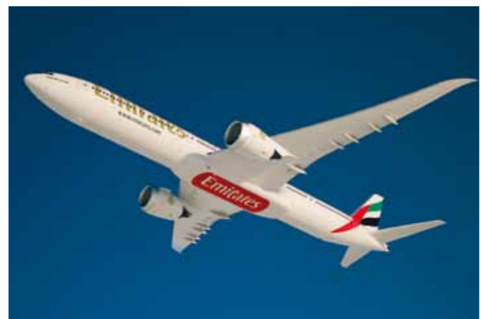
Die Boeing 777X erhält um sieben Meter verlängerte Kunststofftragflächen.
