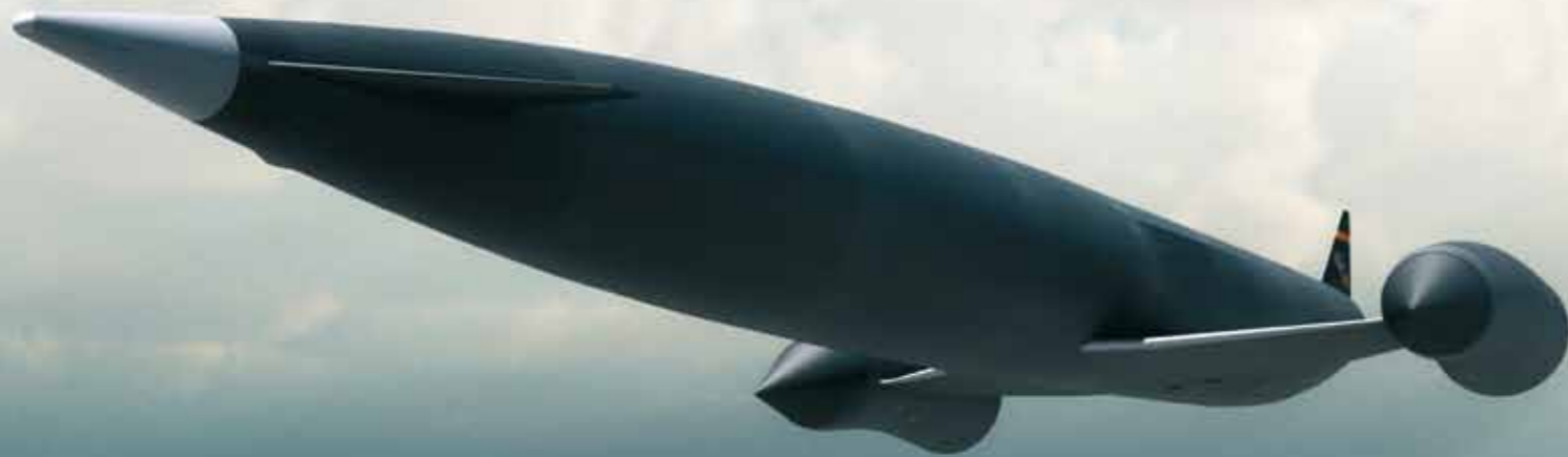
Skylon soll als wiederverwendbare Raumfähre eine Nutzlast von 15 Tonnen transportieren können.
